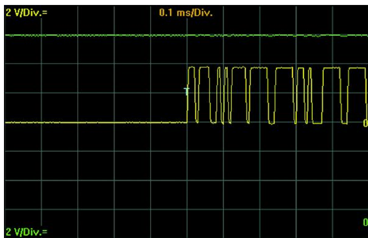
图 5-12CAN-Low 线对蓄电池短路
