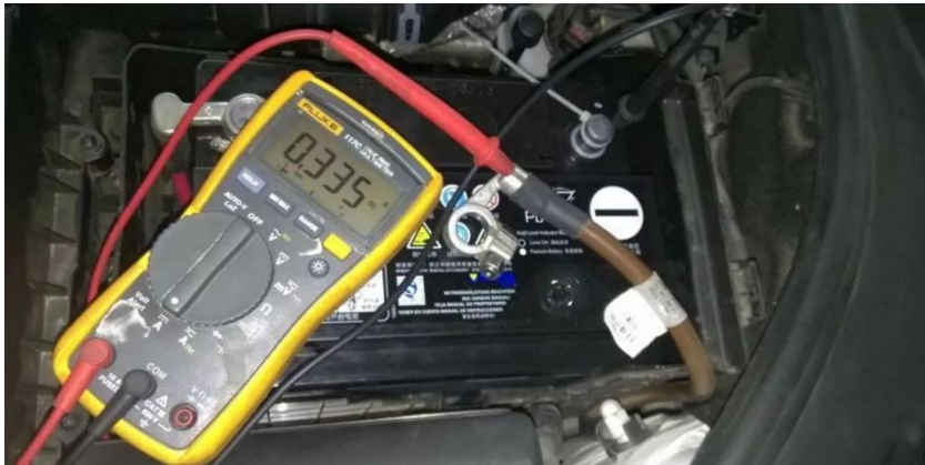
图 3-102 检测静态电流的方法
