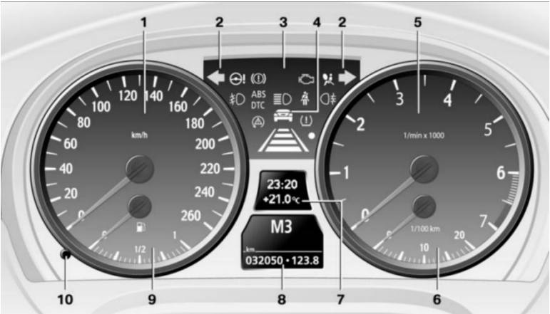
1-车速表；2-转向信号灯的指示灯；3-指示灯和报警灯；4-主动巡航控制显示；5-转速表；6-能量控制；7-显示屏，用于显示：时钟、车外温度、指示灯和报警灯；8-显示用于：自动变速器档位、保养需求日期和剩余的行驶里程、里程表和里程分表、设置和信息等；9-燃油表；10-里程分表复位；
