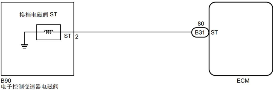
图 10-6 换档电磁阀 ST 电路图
