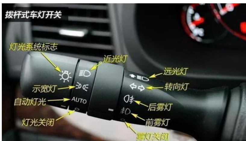
图 4-27 拨杆式车灯开关
