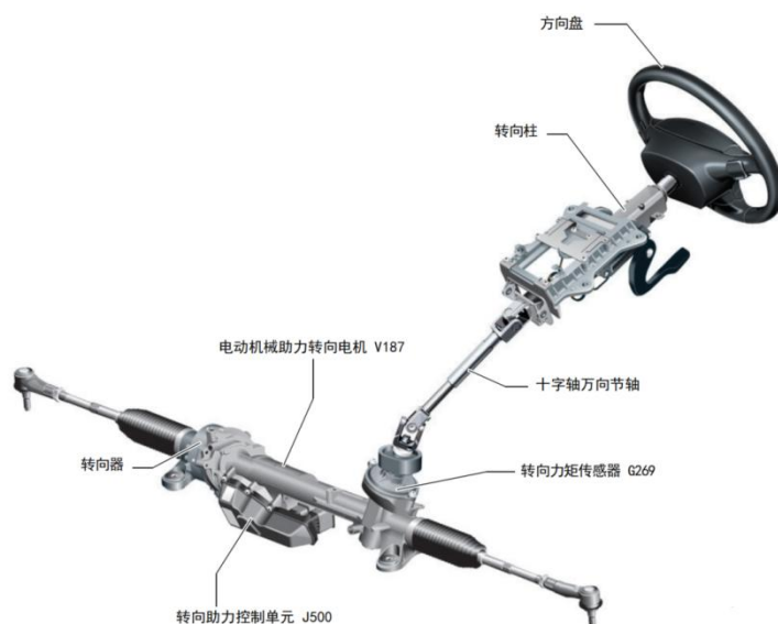
图 9-1 电动转向系统的组成
