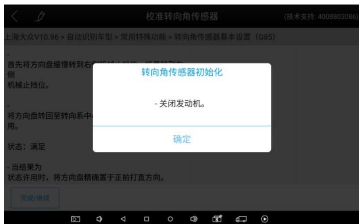
图 9-13 按显示步骤操作 转向角传感器初始化成功，返回。
