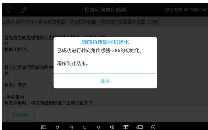
图 9-14 转向角传感器初始化成功 再次进入 03 制动电子装置读取故障码显示为“未检测到故障码”。
