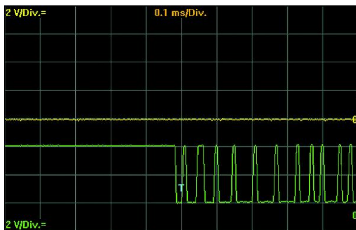
图 5-14 CAN-High 线信号对地短路
